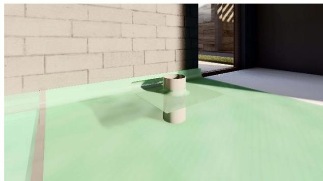
2. Recouvrir la canalisation d'une embase ajustée de film anti-radon à positionner au pied du tube.
