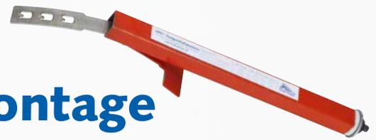
La clé tangentielle doit être utilisée pour le montage des manchons VPC® de 290 à 995. Tout d'abord, déterminer la plage de serrage des tuyaux devant être raccordés et choisir la manchette appropriée. Appliquer du lubrifiant sur les bouts et la glisser sur le tuyau ayant le plus grand diamètre nominal. Une fois que le manchon est correctement orienté, placer la clé tangentielle VPC® avec son support sous les colliers de serrage. Ensuite, accrocher l'ailette du bras de
