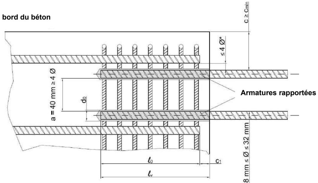
\* Si la distance libre entre les barres d'armature comportant un recouvrement est supérieure à  $4 \varnothing$ , alors la longueur de recouvrement doit être augmentée de la différence entre l'espacement réel et  $4 \cdot \varnothing$ .
