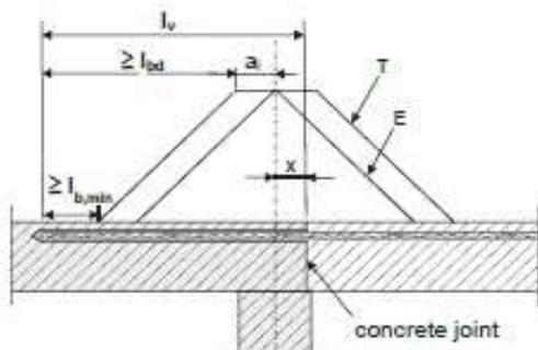
**Figure 1.5:** Ancrage direct d'armatures pour reprendre les efforts de traction.
