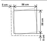
Découper entre solives ou fermettes. Positionner la trappe à au moins 5 cm de tout mur ou cloison.
