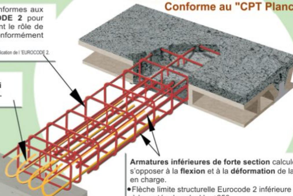
Armatures inférieures de forte section calculées pour s'opposer à la flexion et à la déformation de la poutre en charge.
