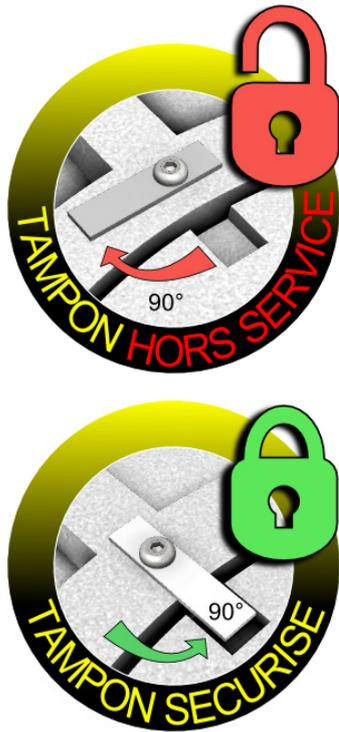
A la livraison, le tampon est non sécurisé (les 2 pattes ne sont pas dans l'alignement des encoches du tampon) afin de faciliter son démontage.
