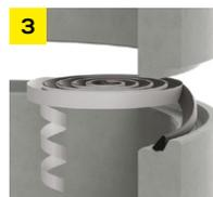
3 Mettre en place le cordon sur l'emboîtement et ôter la protection
