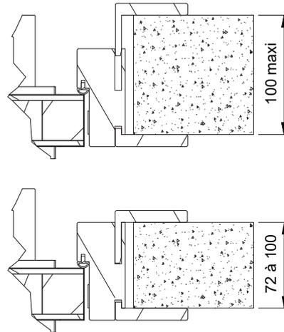
Avec Kit Extension cloison > 100 mm
