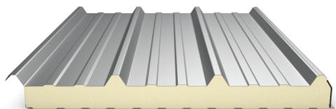
**Panneau sandwich Ondatherm T - ép 40 mm R 1,80 - 5,20 x 1 ml - Ral extérieur Gris 7016 25 $\mu$  - intérieur Blanc 9010 12 $\mu$  - Démoussage 200 mm - TG**
